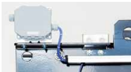
Dispositif de mesure de la température
